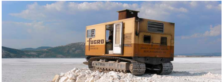
In onze buurlanden wordt de sondeerwegen veelvuldig ingezet bij milieuonderzoek, zoals op de foto tijdens onderzoek bij een gesloten mijn in het oosten van Duitsland.
